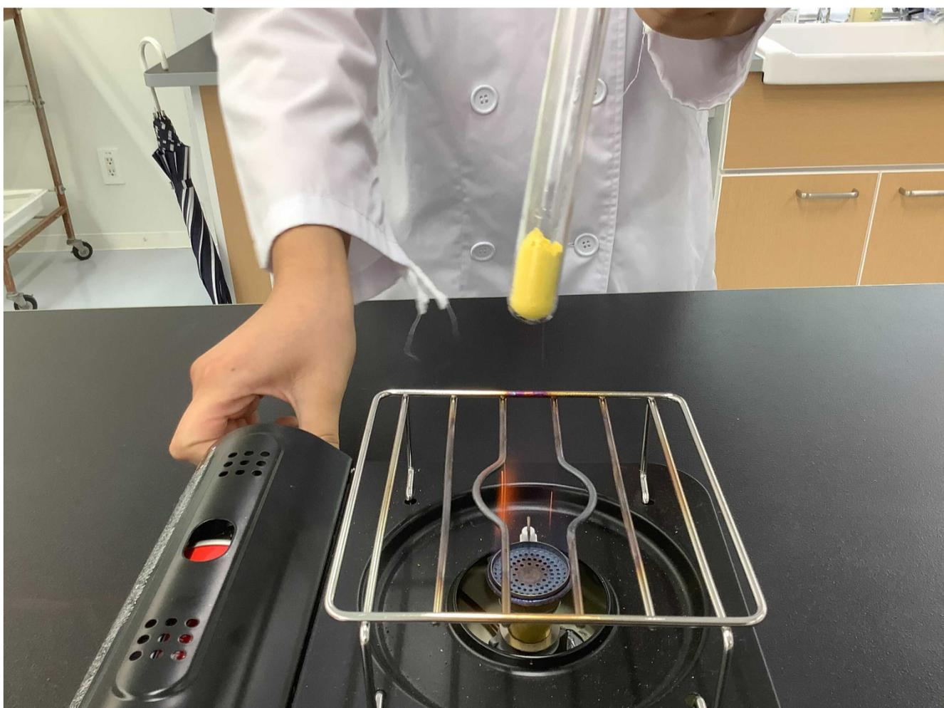
◀ シュウ酸鉄を加熱すると二酸化炭素と鉄に分解される
